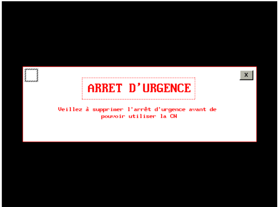
Figure 27 : Capture d'une page pop-up de l'IHM : Détection arrêt d'urgence
